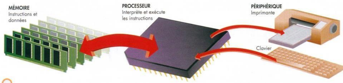
Figure III-2 structure d'un microcontrôleur
