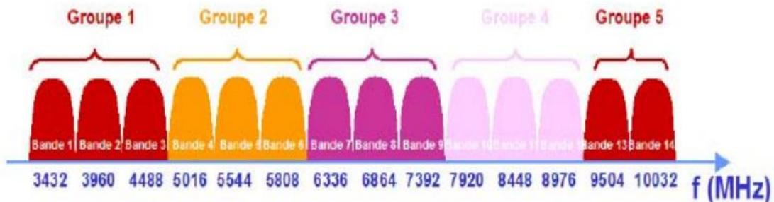
Figure 1-7 : Bande OFDM définie par la norme 802.15.3a
