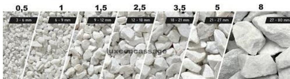
Figure 1.4: Différent dimension du granulat
