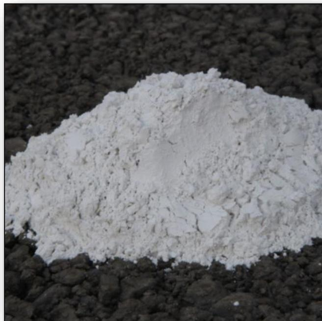
**Figure 4.3: laitier de haut fourneau.**
