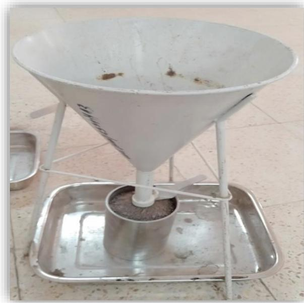
Figure 5.6: Entonnoir et récipient de mesure
