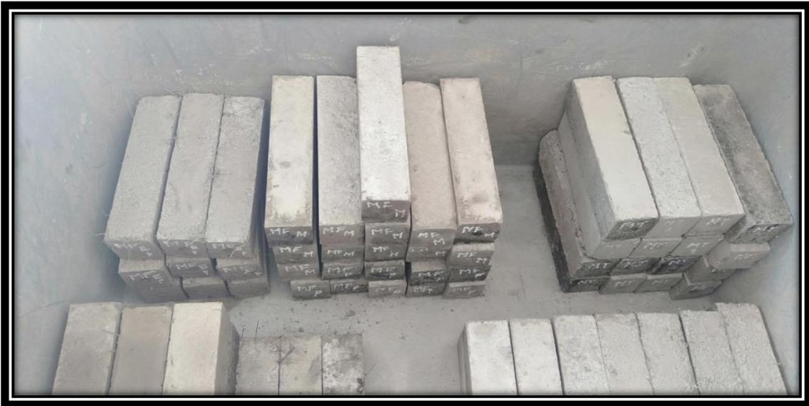
**Figure 6.1: Préparations des éprouvettes des mortiers**
