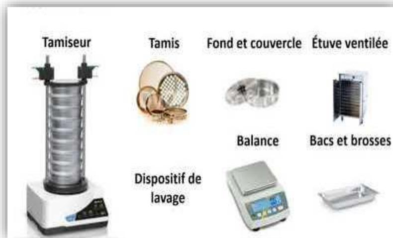
**Figure 5.8: Matériel nécessaire de l'essai Analyse granulométrique**
