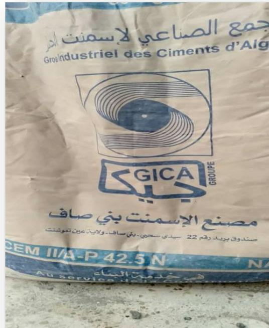
**Figure 5.1: Le ciment utilisé CEM-II/AP 42.5**
