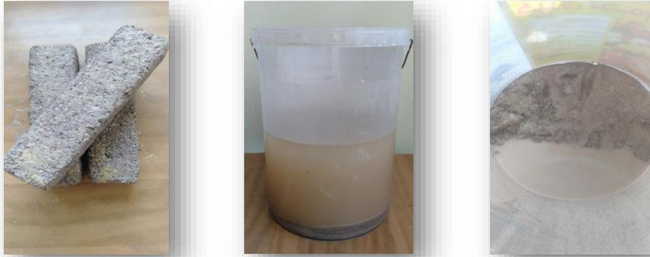
**Figure 6.4: Résultat visuel dans le milieu acide sulfurique (H<sub>2</sub>SO<sub>4</sub>) après prélèvement des éprouvettes dans les bacs de conservation**
