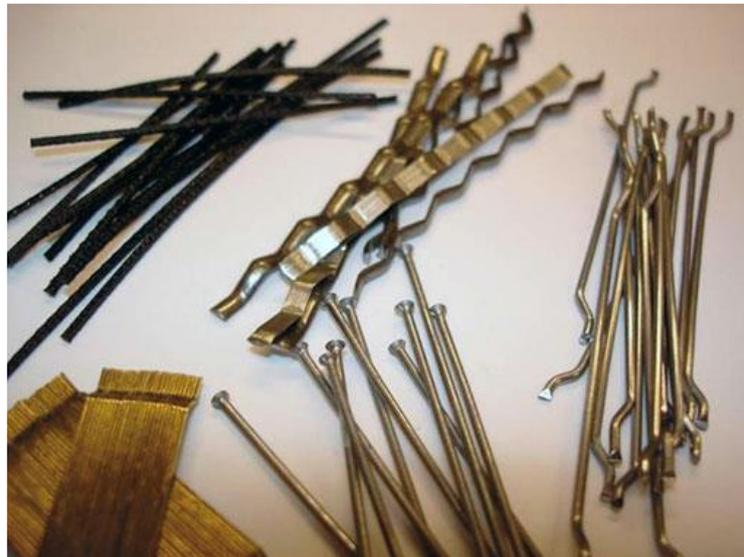
**Figure 3.6:Fibres Métallique**
