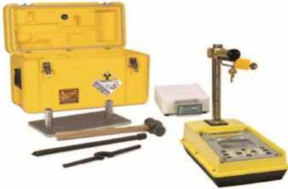
**Figure 55:** photo d'un nucléo densimètre [18]
