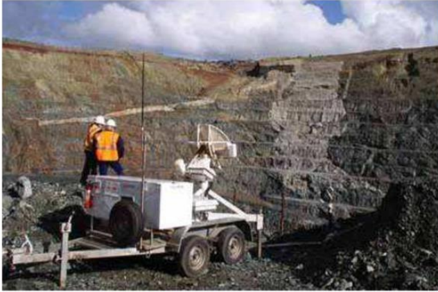
Figure 53: Radar par principe d'interférométrie
