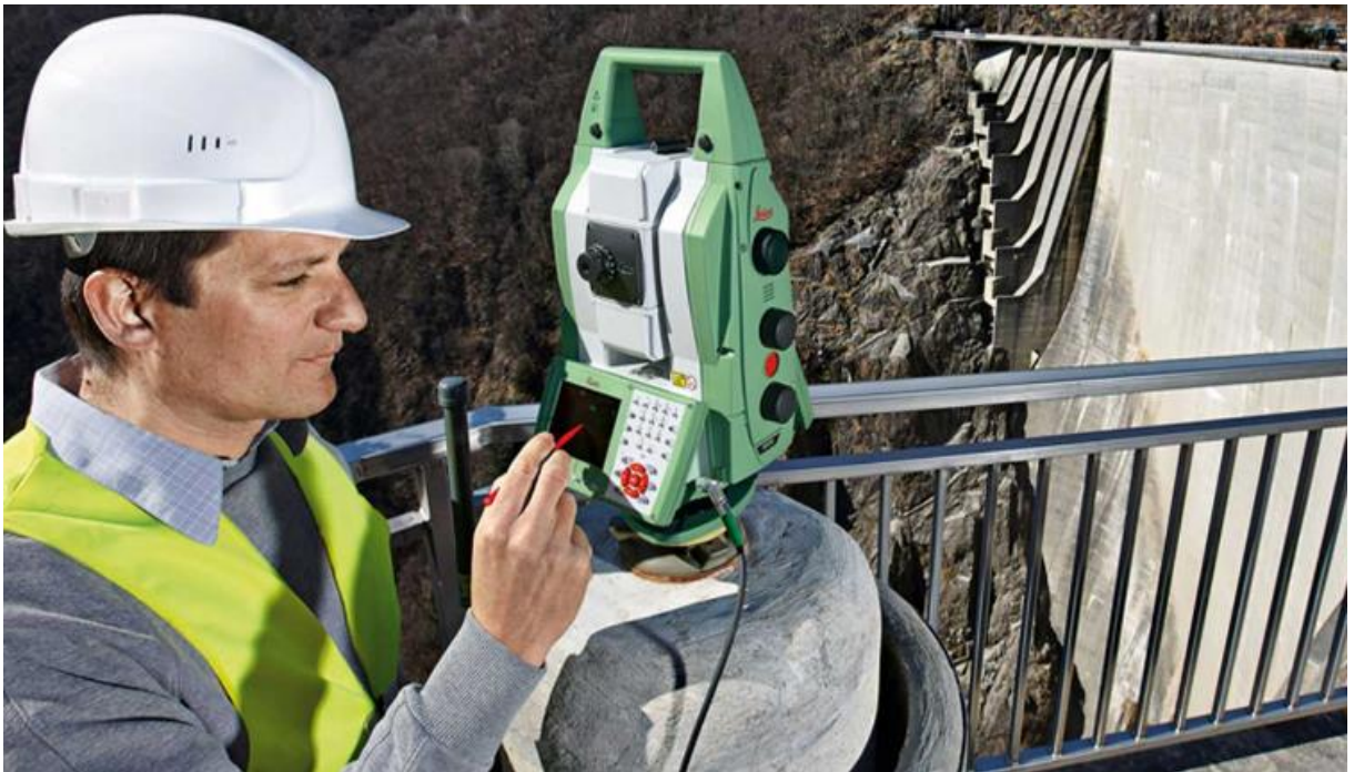
Figure 58 : utilisation du logiciel Leica Geomos pour l'auscultation des barrages
