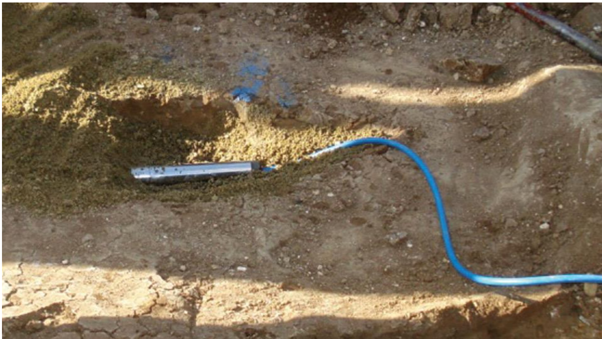
Figure 43 : Cellule à corde vibrante [11]
