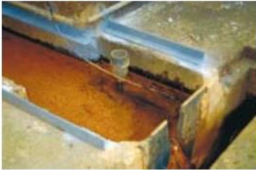
Figure 35 : Dispositif de mesure automatique télétransmise d'un débit de fossé de drainage, seuil triangulaire et capteur à ultrasons. [25]
