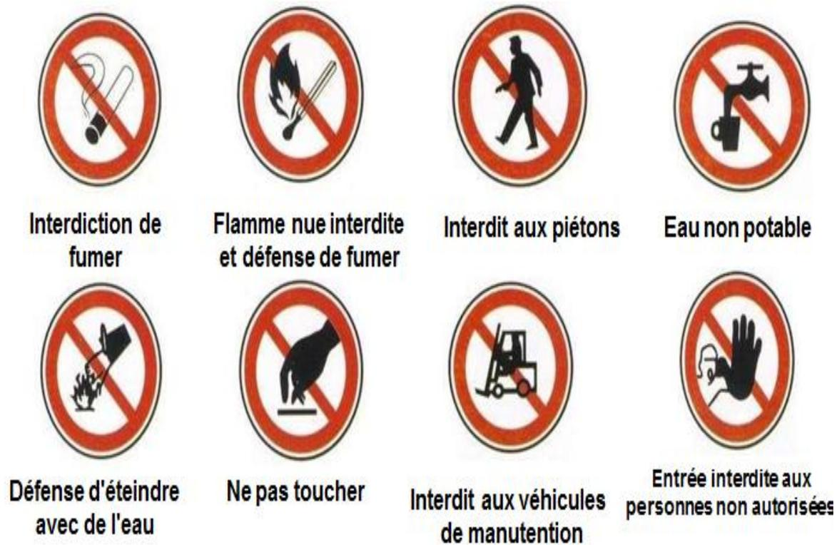
Figure 12 : Panneaux d'interdiction
