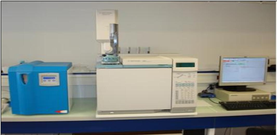
**Figure 5 :** Matériel de mesure : Chromatographes en phase gazeuse
