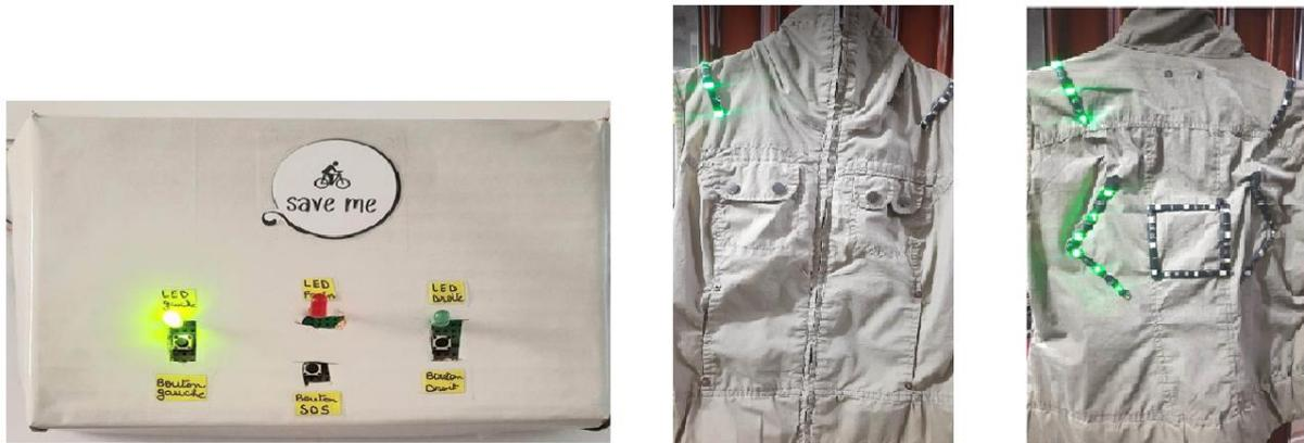
**Figure III.6 :** Résultat de test d'indication de direction gauche.
