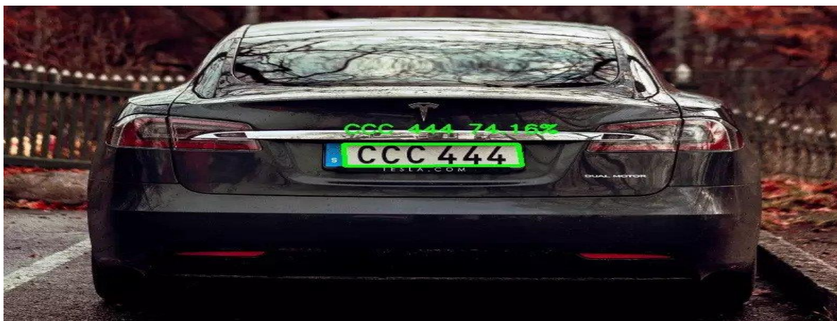
Figure 24 : détection d'une plaque d'immatriculation sur une voiture
