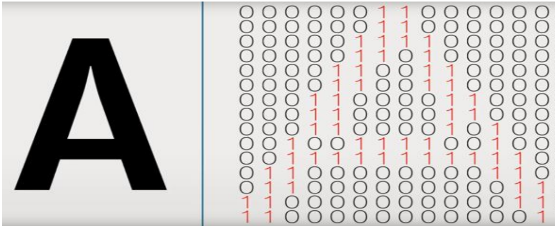
Figure 14: Conversion d'un "A" en matrice binaire
