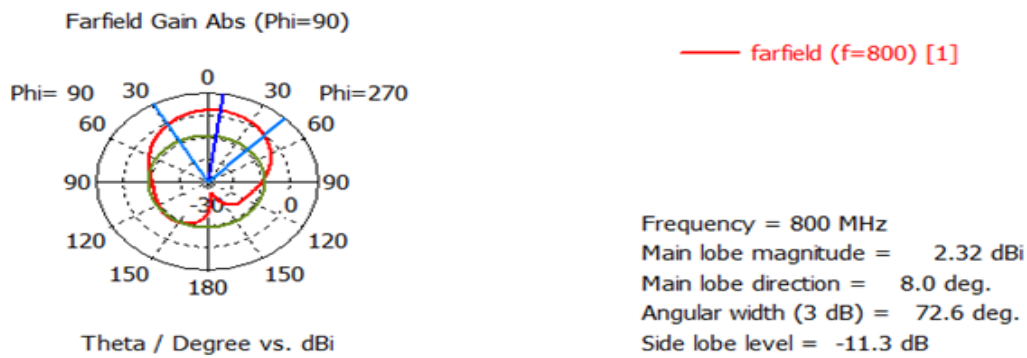
Figure III.13 : Diagramme de rayonnement polaire (Gain) de l'antenne initiale proposée.
