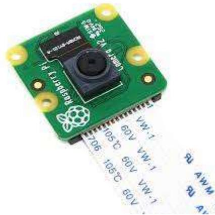
**Figure III.3:** Caméra Raspberry Pi
