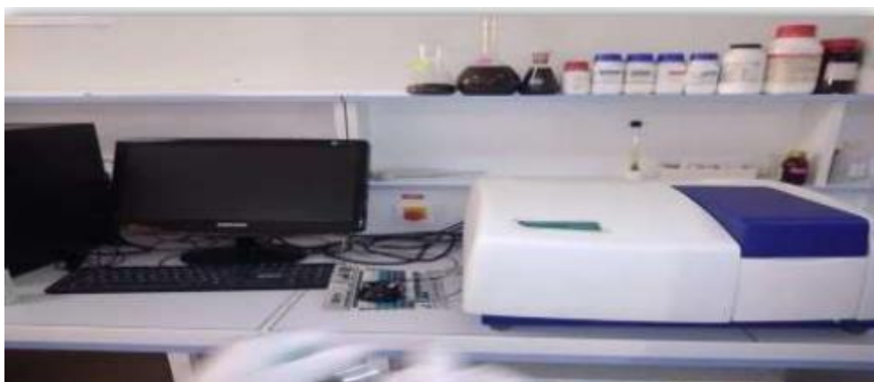
Figure II.13: Appareil d'UV-Visible de l'université d'Ain temouchent.
