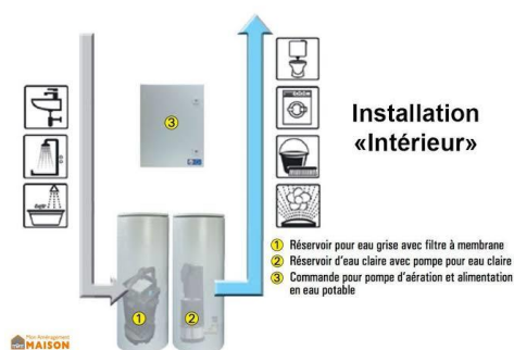
Figure 8: system de filtrage d'eau grises
