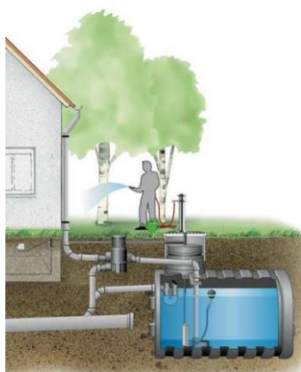
Figure 7: system de collecte de l'eau de pluie
