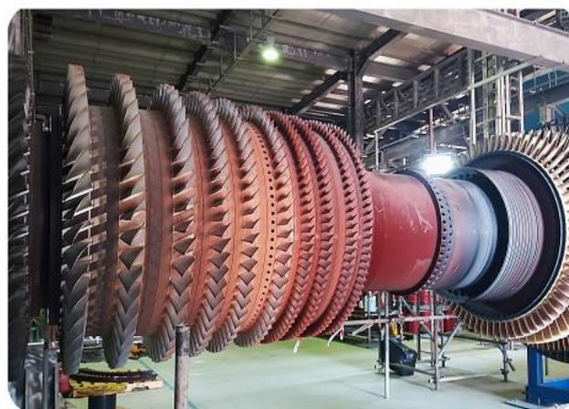
**Figure II.5 :** disques supportés par l'arbre d'une turbine
