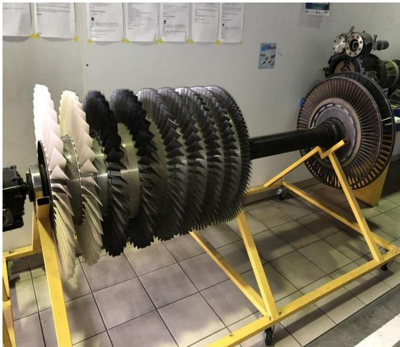
**Figure II.2 :** rotor d'un turboréacteur d'avion
