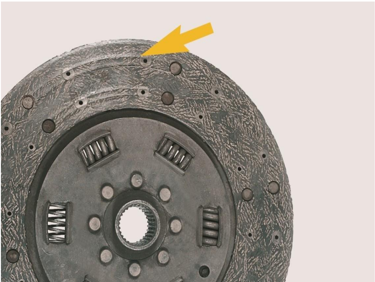
Figure II.1 : Garniture usée jusqu'aux têtes de rivets [31]
