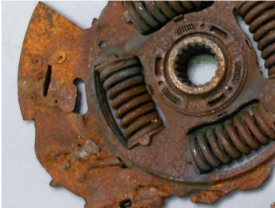
Figure II.12 : Des amortisseurs corrodés [40]
