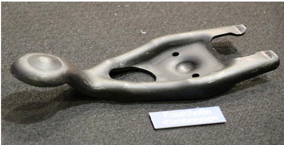
Figure I.23 : Fourchette en forme U [1]
