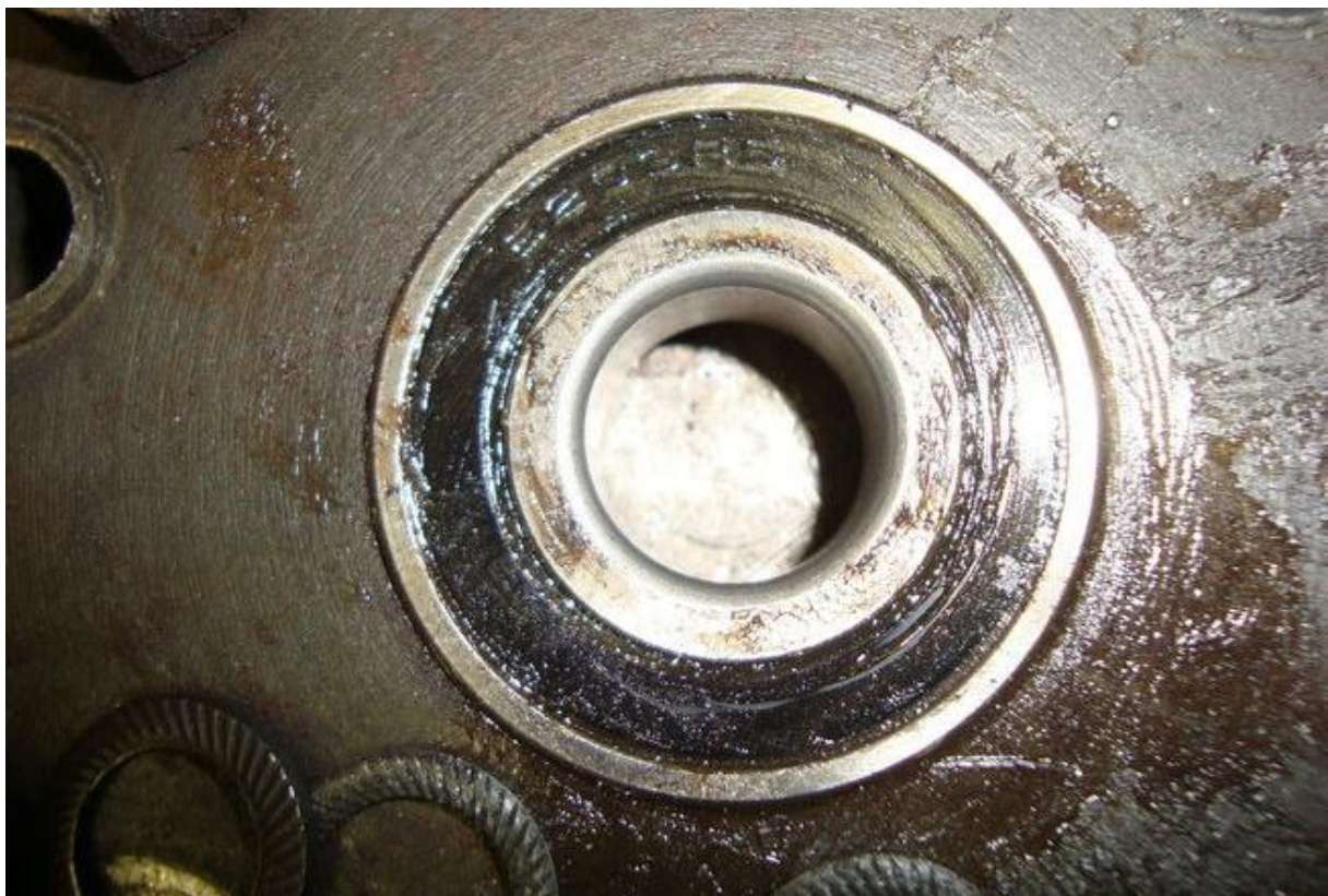
Figure II.11 : Bague d'appui défectueuse [39]
