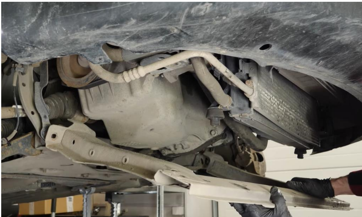
Figure III.9 : Réinstallation du demi-berceau [45]
