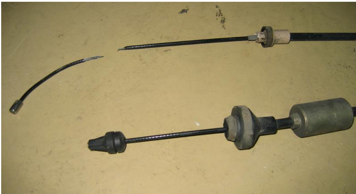
Figure II.3 : Câble d'embrayage cassé [33]
