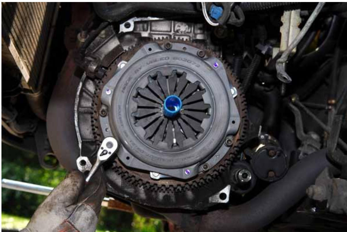
Figure III.5 : Revissage du disque et mécanisme [44]
