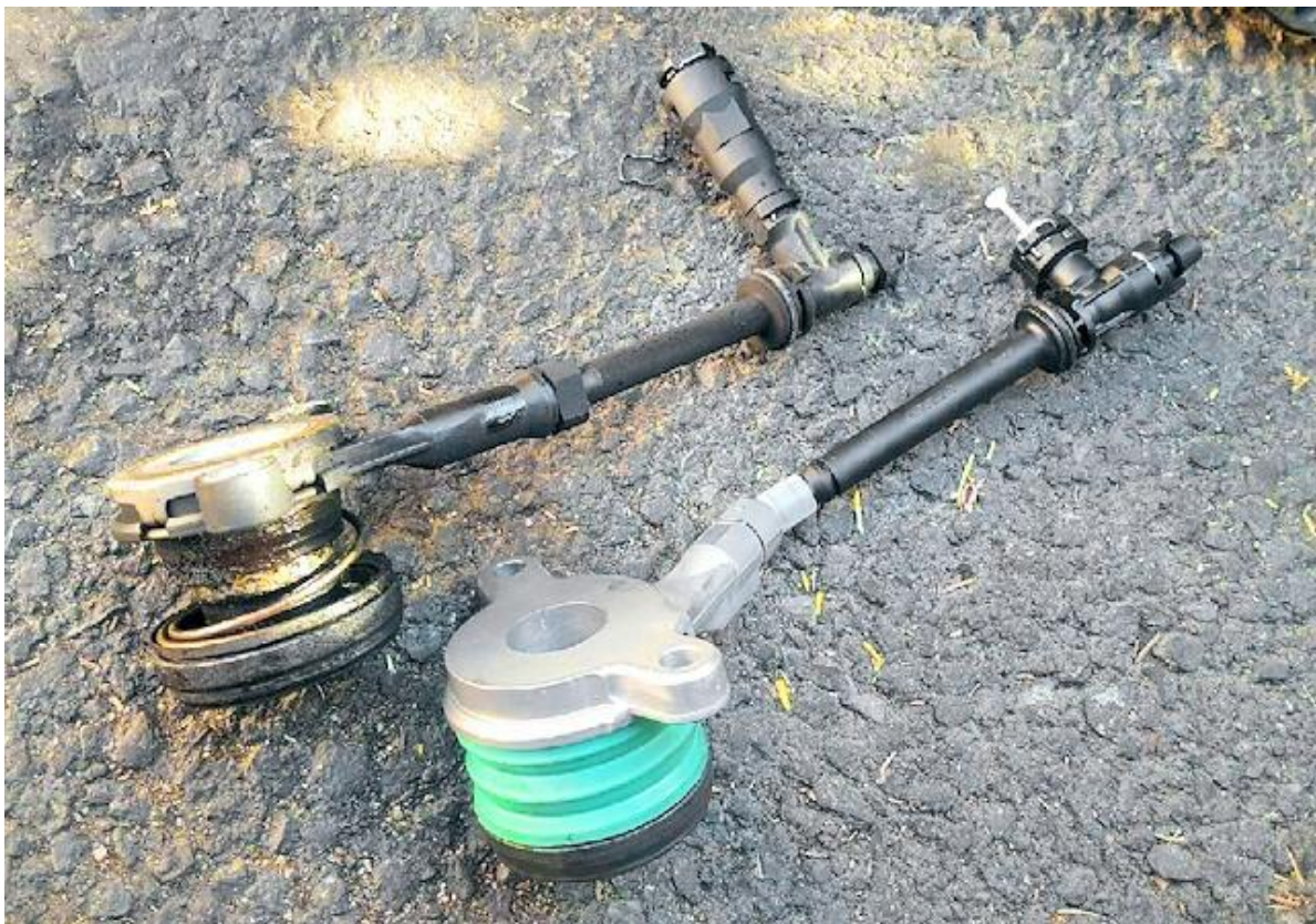
Figure II.5 : La différence entre une butée neuve et une butée usée [35]
