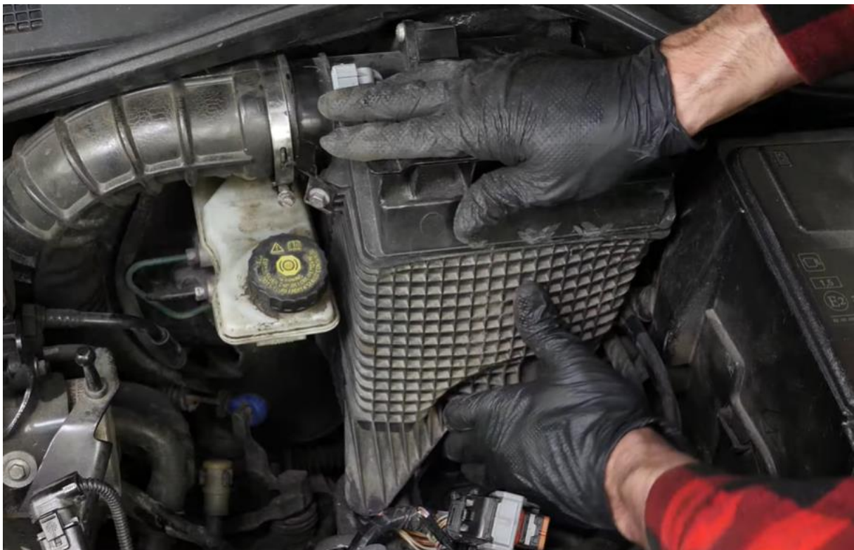
Figure III.10 : Réinstallation de la boîte à air [45]
