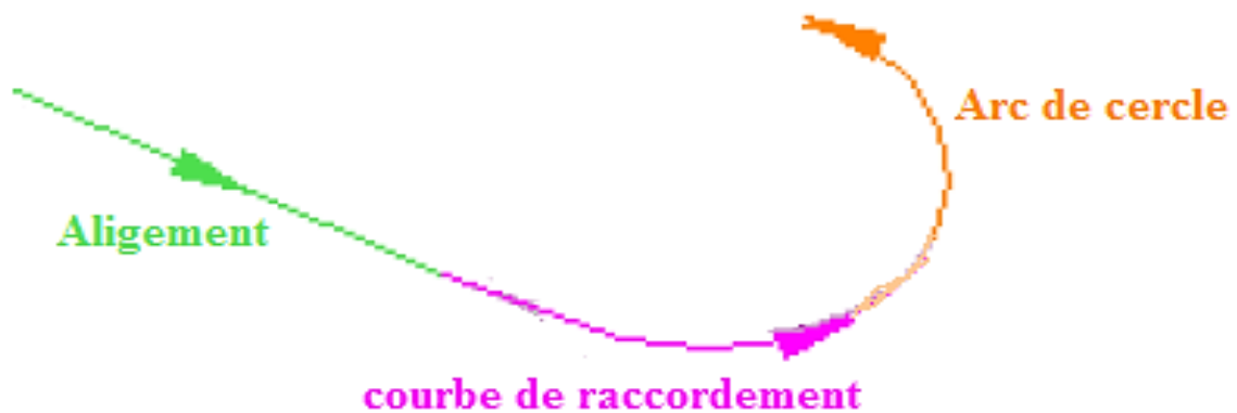
Figure 4 : Les éléments de la trace en plan [7]
