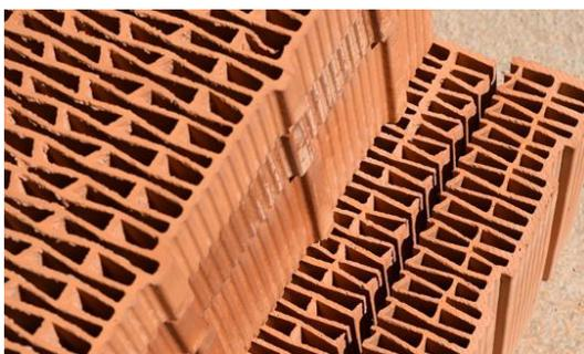
Figure 13:Briques creuses[7]
