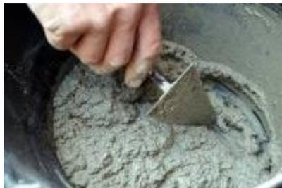
Figure 15: Mortier de ciment[9]
