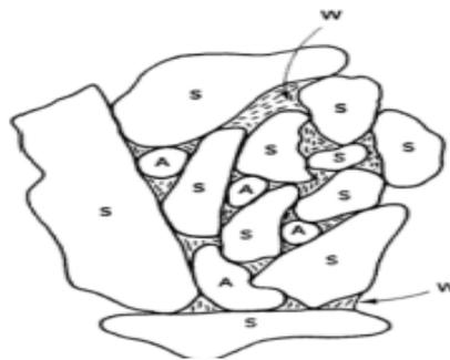
**Figure 27:** Portion de sol constitué de grain solide S entouré de vides remplis d'air A et d'eau w
