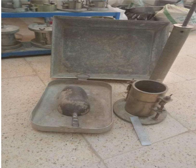
**Figure 37:** Les équipements utiles pour l'essai Proctor[2]
