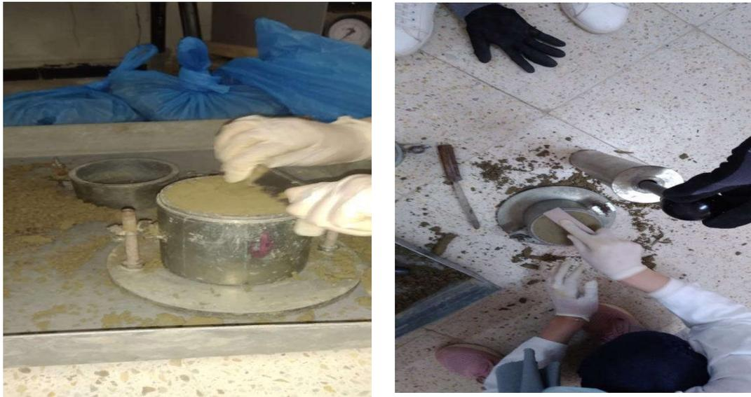
**Figure 38:** L'essai de compactage (Proctor normal)[2]
