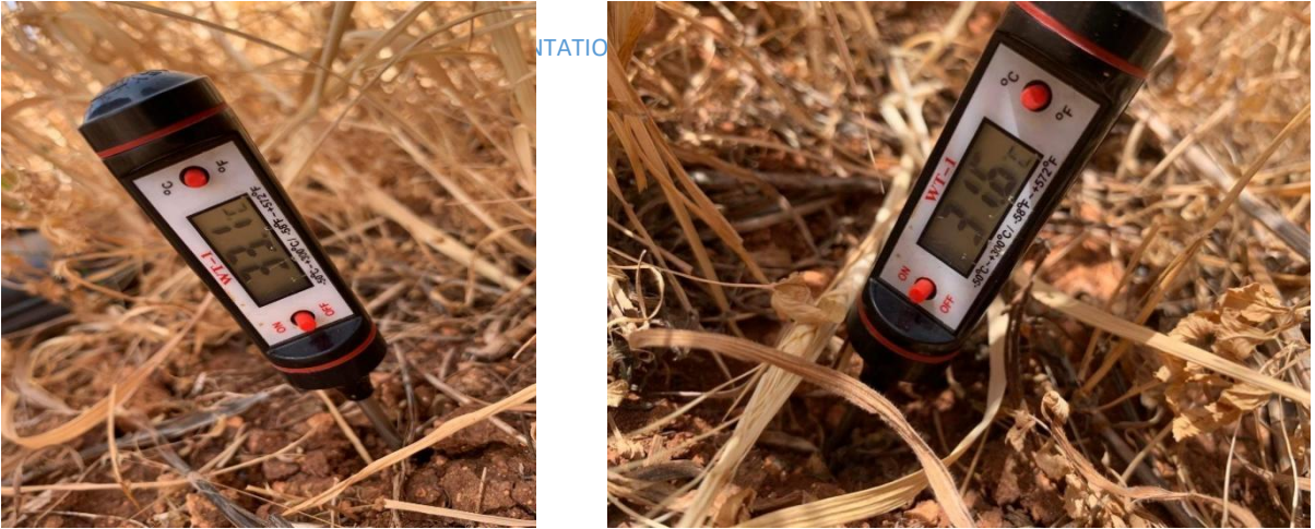
Figure 5 : Mesure de la température du sol des parcelles expérimentales.
