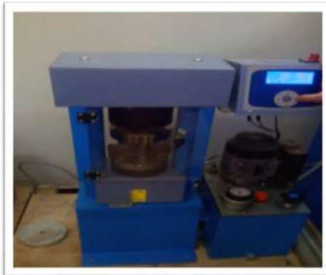
**Figure 2.22 :** Machine de compression et de flexion.
