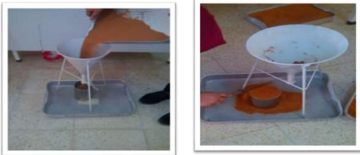
**Figure 2 .9:** Les matériaux de la masse volumique apparente
