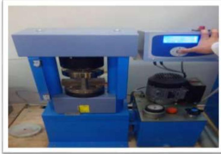
**Figure 2.23** : écrasement des éprouvettes du mortier
