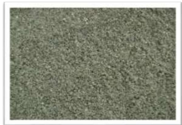
**Figure 1.5:** les sables de concassages calcaire. [6]
