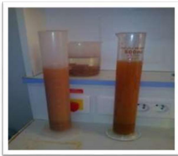
**Figure 2 .8:** Résultat d'équivalent de sable
