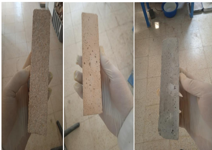
Fig.III.4 : Perte en masse des mortiers conservés avec solutions acides Par ordre ( H_2SO_4 -HCL-NaOH)
