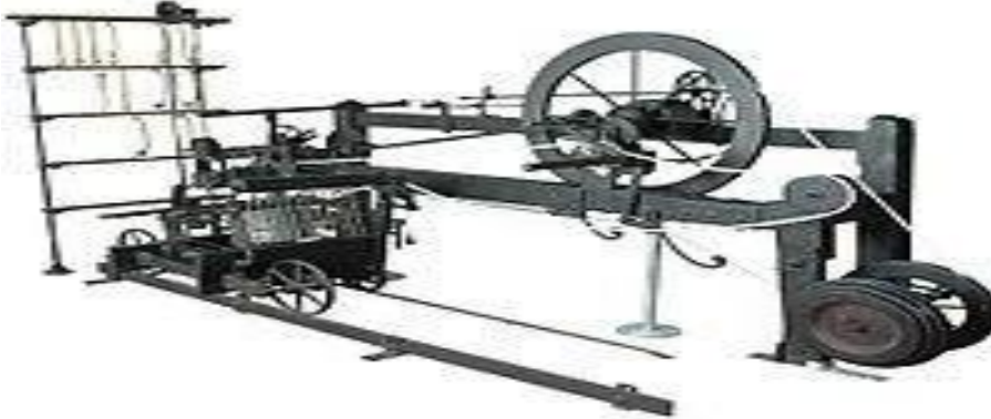
Figure2: Le seul exemple survivant d'une mule tournante construite par l'inventeur Samuel Crompton[8]
