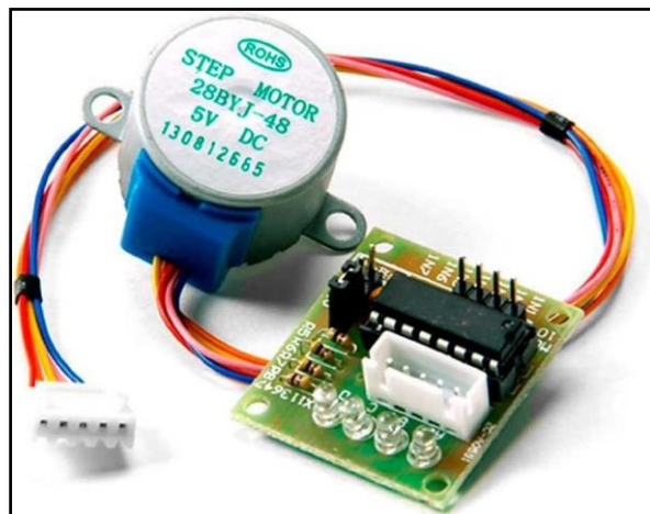
Figure 3.4 : Moteur pas à pas 28byj-48 avec Driver ULN 2003A [21]
