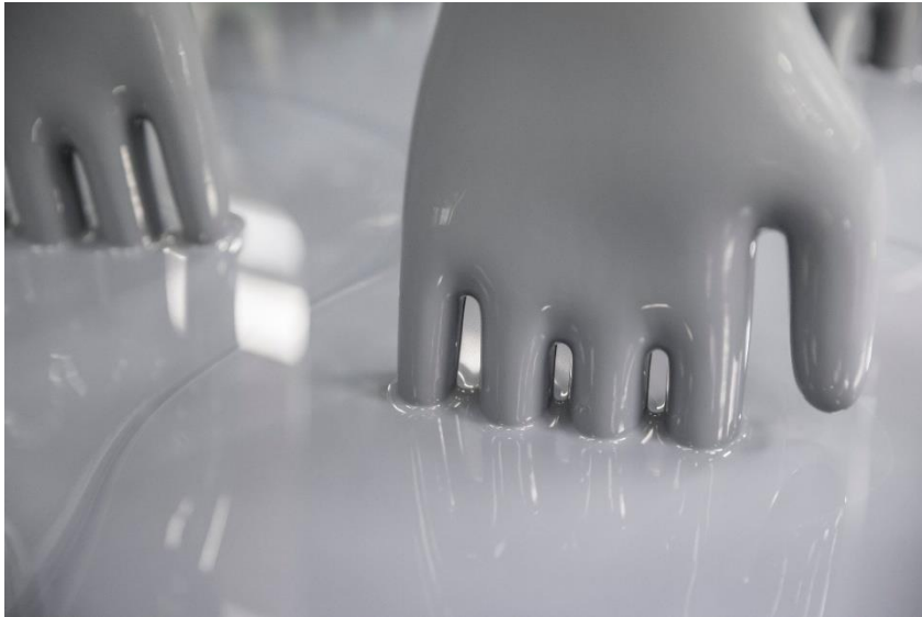
Figure 2 : Trempage de coagulant. [13]
