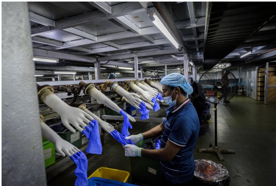
Figure 4 : retrait des gants médicaux des moules.[15]
