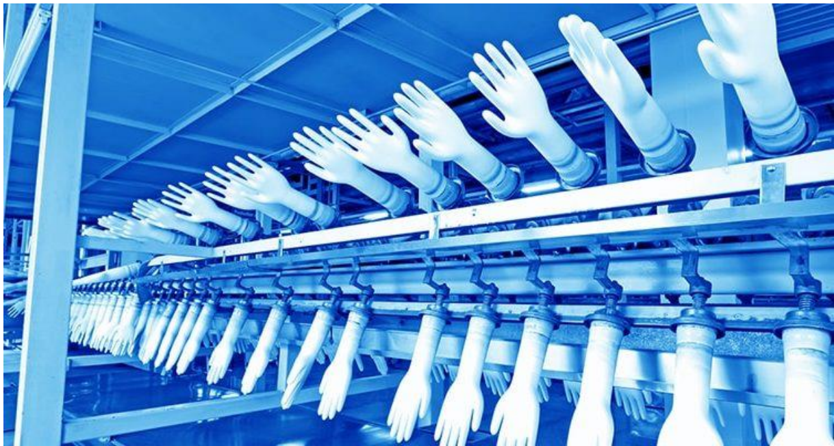
Figure 1 : procès de production des gants.[12]
