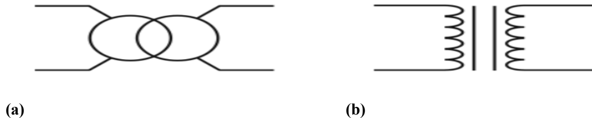
Figure (I.2) : Symbole d'un transformateur [4].
