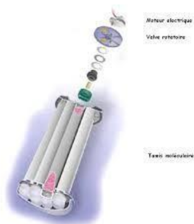
Figure II.5 : Décomposition du barillet du module ATF
