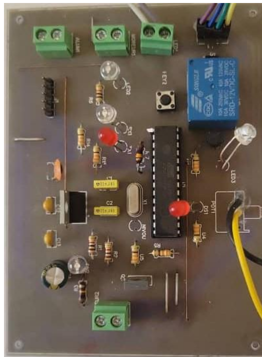
Figure III.8 : Carte mère pour Controller notre system
