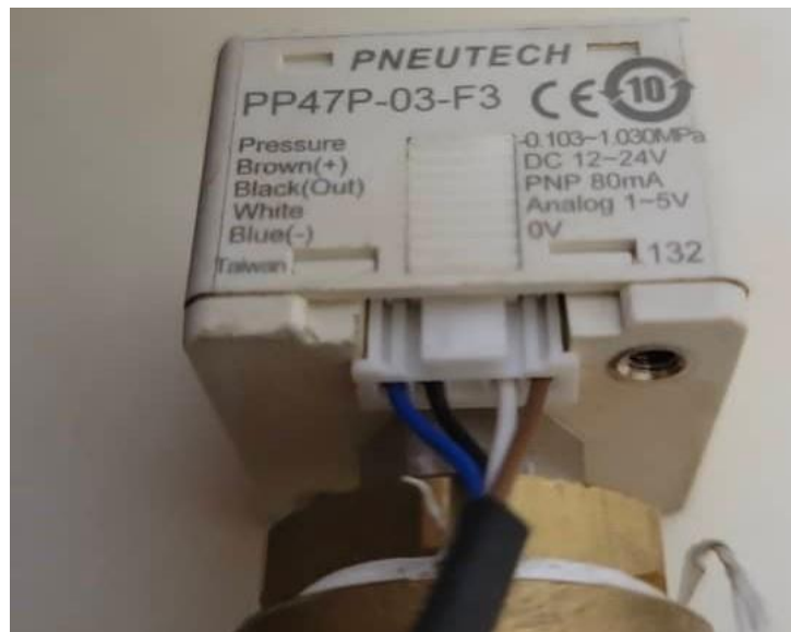
Figure III.4 : Capteur de pression PP47P-03-F3
