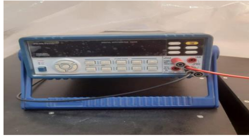
Figure II 5 Multimètre peak Tech digitale multimètre 4000, \frac{3}{4} -digit
