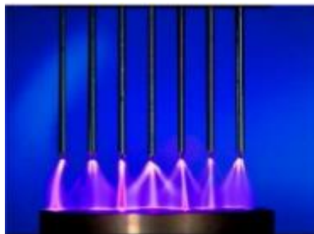
Figure I 5 Aspect lumineux de la décharge couronne dans une configuration multi-pointes
