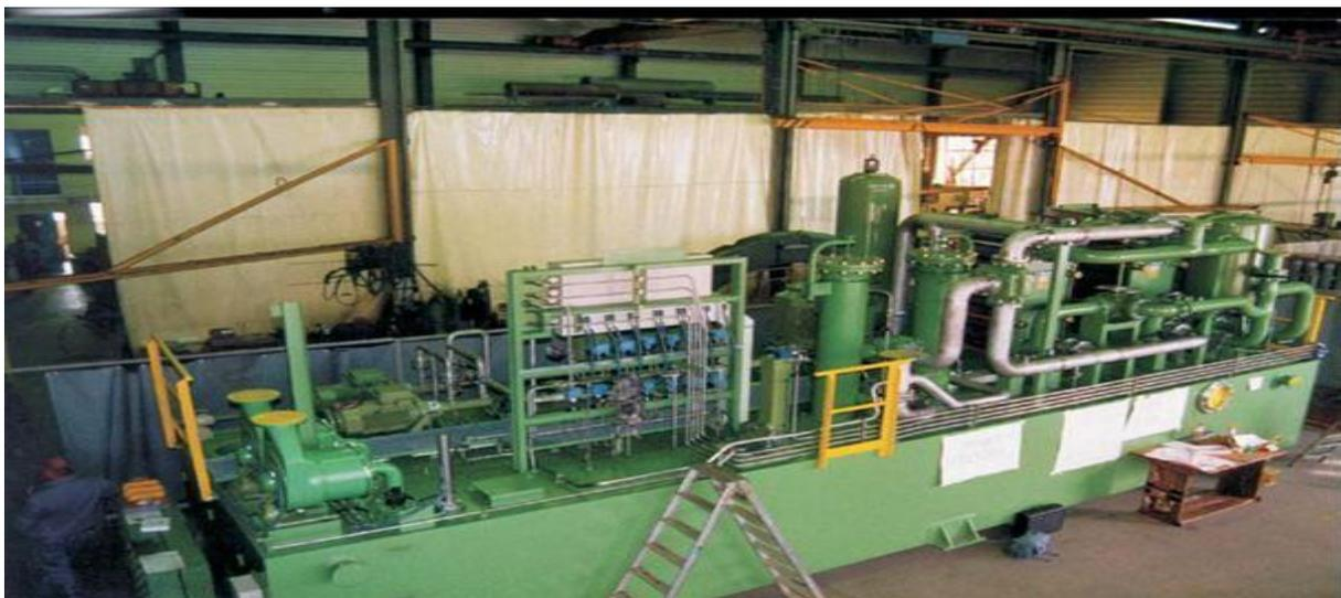
Figure (I. 11) Système d'huile de graissage. [10]
