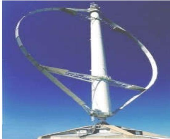
**Figure I -11: éolienne à axe verticale**
