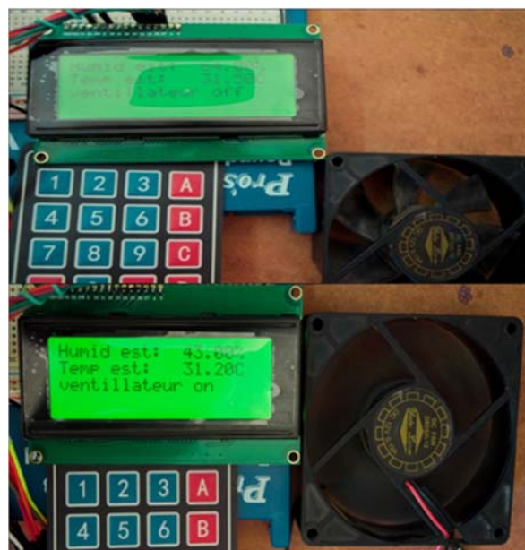
Figure III.9– système de température et d’humidité, état ON/OFF
