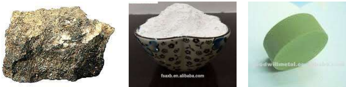
Figure I. 16 :Oxyde d'étain ( \text{SnO}_2 ) massif sous forme naturelle (a) , poudre (b) et massif (c).
