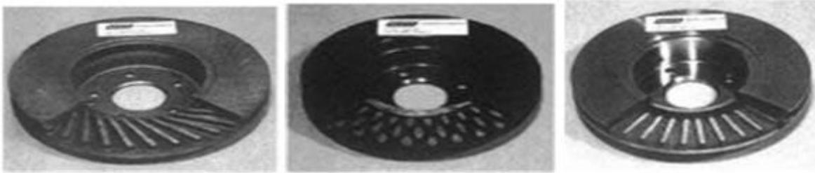
Figure 14: Différentes géométries d'ailettes.(1-14)
