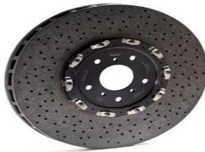
Figure 20: Disque carbone-céramique(1-20)
