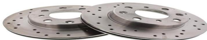
Figure 18: Disque percé(1-18)
