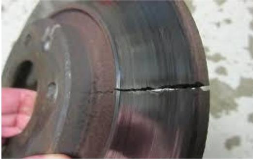
Figure 25: Section de disque fissuré(1-26)
