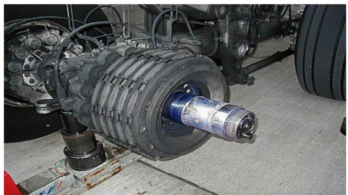
Figure 6: Exemples de freins à disque(1-6)
