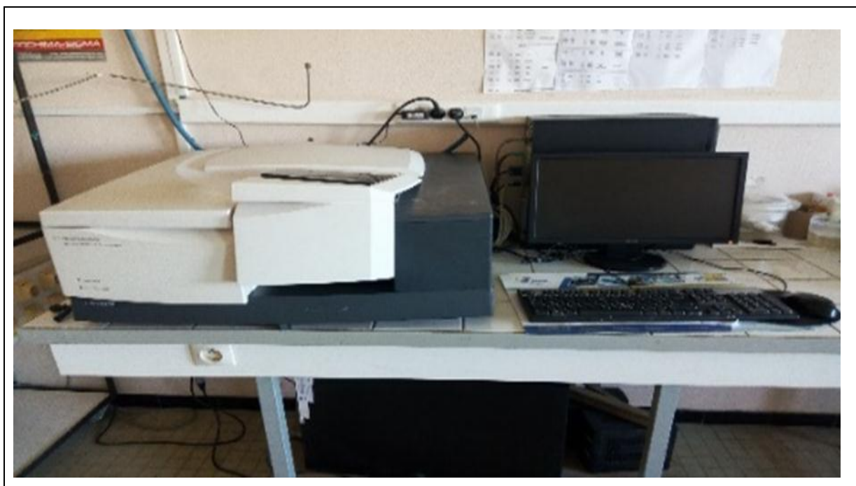
Figure II-4: Agilant technologies cary 640 série IRTF.
