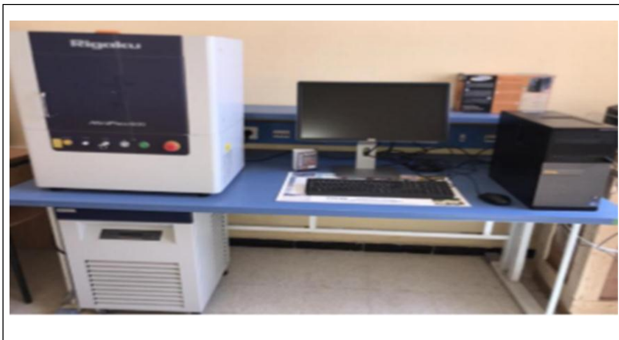
Figure II-1: Diffractomètre Rigaku MiniFlex 600.
