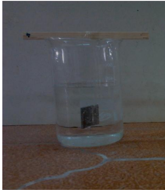
Figure II.5 : Dispositif expérimental de la méthode de perte de la masse
