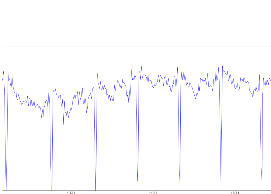
Figure 27 : signal ECG du AD8232
