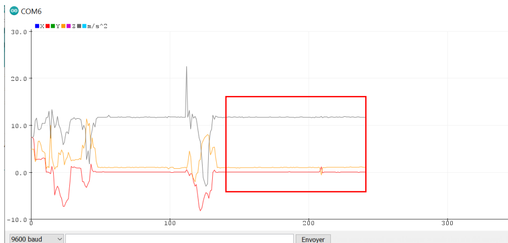
Figure 24 : résultats du capteur ADXL345 sur le traceur série
