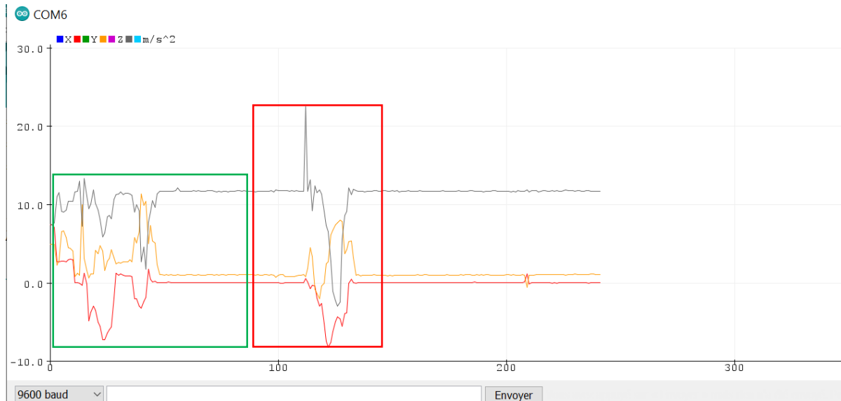
Figure 22 : résultats du capteur ADXL345 sur le traceur série
