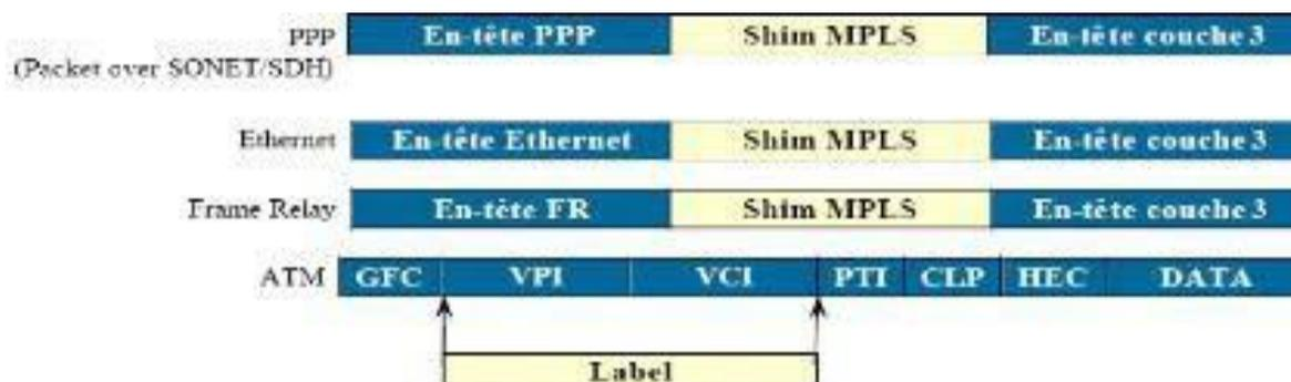
Figure II. 5. Encapsulation des labels dans des différentes trames [14]
