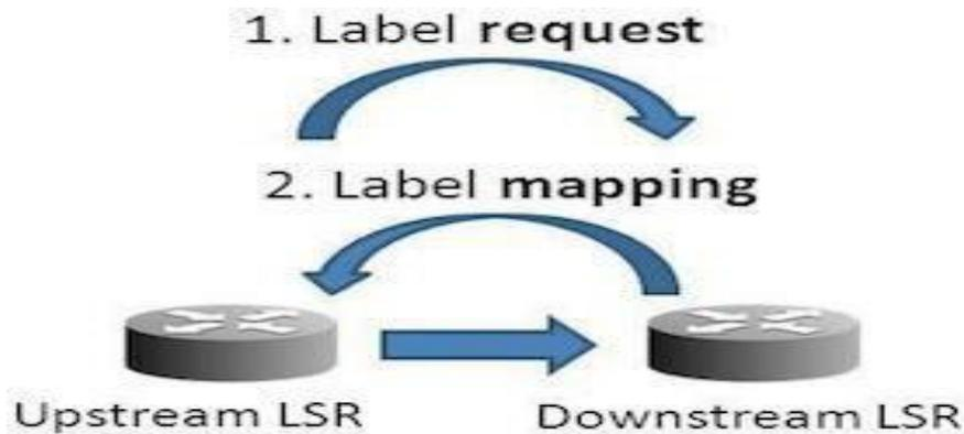
Figure II. 6.Principe du Downstream on demande [14]
