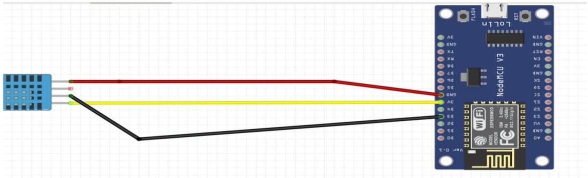
**Figure XXI :** montage de DHT11 avec l'esp8266
