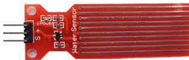
**Figure X : capteur de niveau d'eau.**
