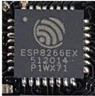
Figure VIII : le module ESP-8266 de Wi-Fi (instructables, ORIG, 2019)
