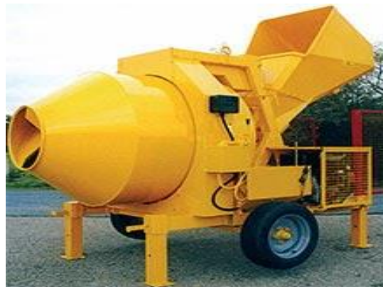
Figure II.6: Bétonnière à tambour basculant.
