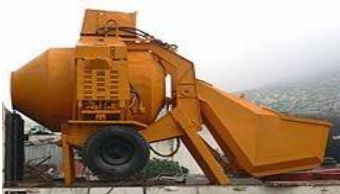
Figure II.8: Bétonnière avec un malaxeur
