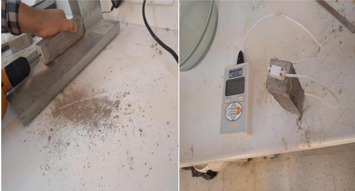
**Figure IV-14: Essai de conductivité thermique.**
