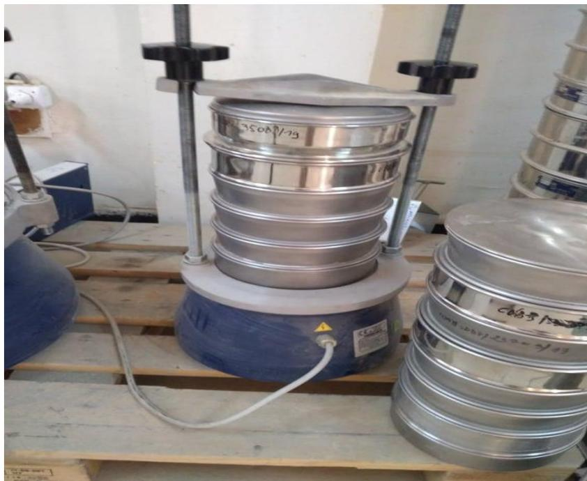
**Figure IV-8 :Analyse granulométrique.**
