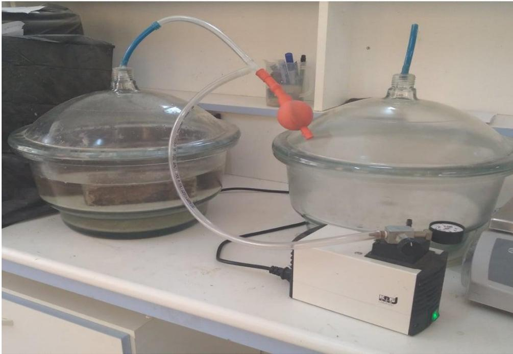
**Figure IV-12 : Essai de porosité**
