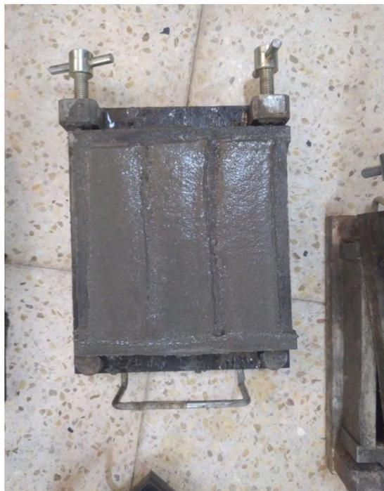
Figure IV-9: Remplissage des moules 4×4×16.
