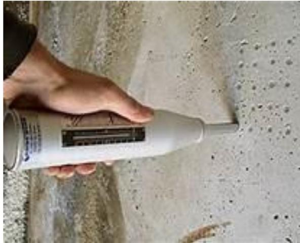
**Figure I-14: Test au scléromètre.**
