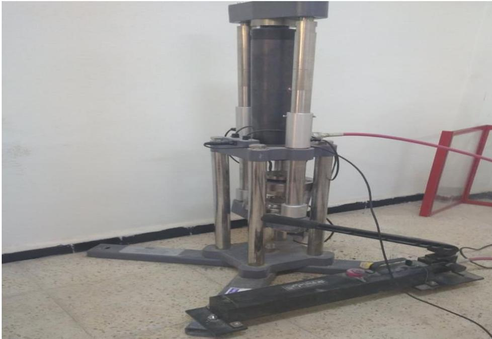
**Figure I-9: Machine d'essai de compression.**
