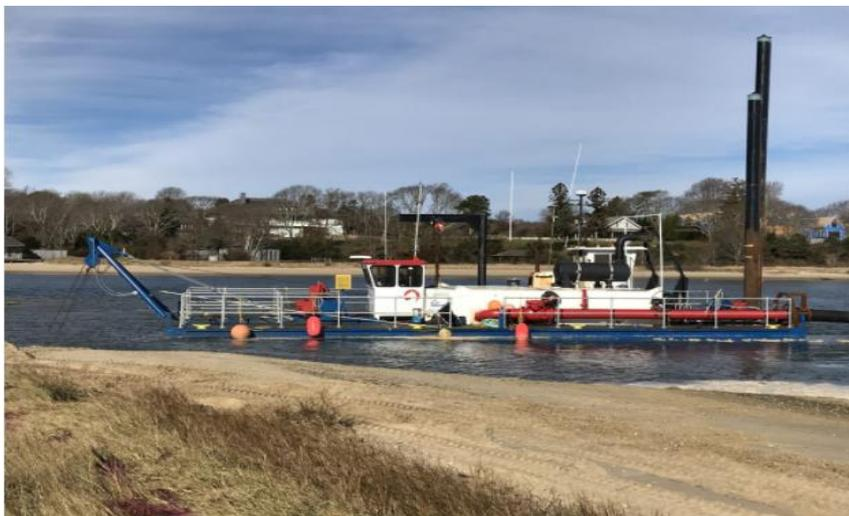
Figure III-11 : Dragage hydraulique[53].
