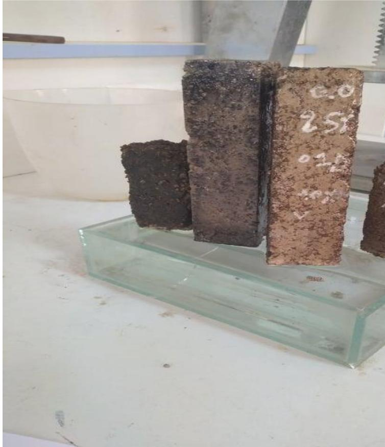
**Figure IV-13: Essai d'absorption d'eau par capillarité.**
