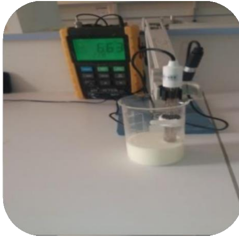
Figure 08 :Démonstration de mesure de pH de poudre du lait utilisée pour la fabrication de Yaourt.
