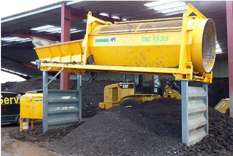
Figure32: Exemple de tamis pour centre de compostage
