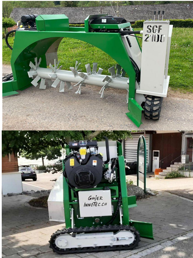
Figure22 : la machine compostage jusqu'à 500 tonnes par an
