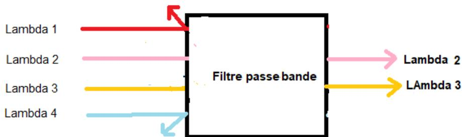
**Figure II. 16:** Un exemple d'un filtre passe bande.
