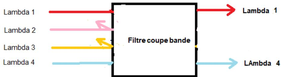
Figure II. 17: Un exemple d'un filtre coupe bande.
