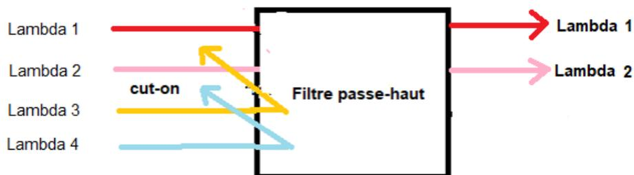
**Figure II. 14:** Un exemple d'un filtre passe-haut.
