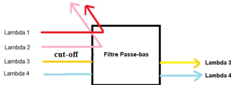
**Figure II. 13:** Un exemple d'un filtre passe-bas.
