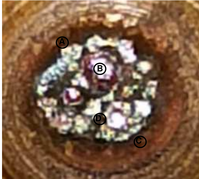
Figure IV- 3 : Aspect typique de l'impact de l'arc électrique sur une électrode (une cathode).il s'agit d'une image réalisée à l'aide d'un appareil photo.
