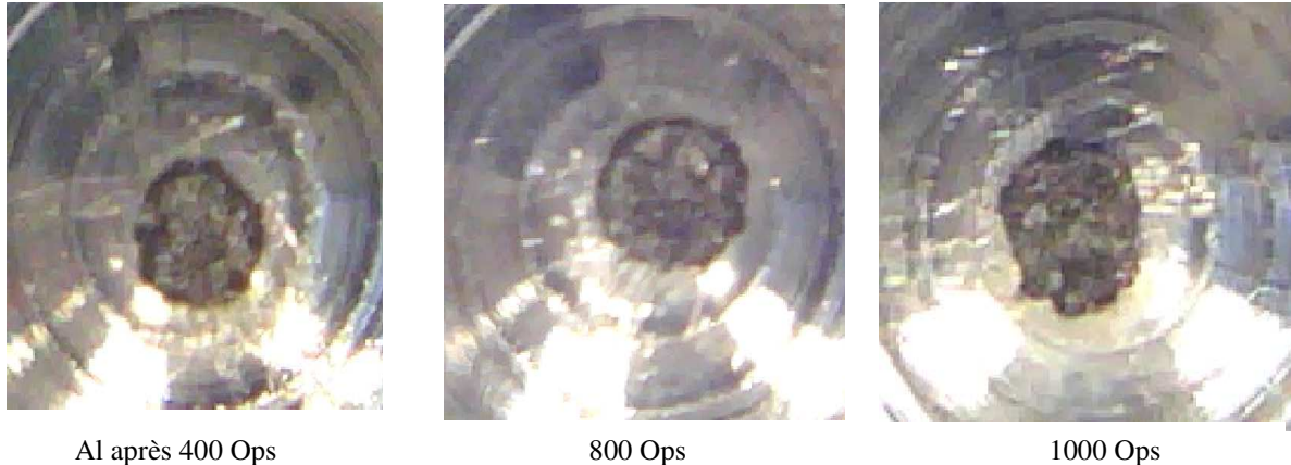
Figure IV- 7 : Surface des contacts fixes Al à différents nombres de manœuvres.
