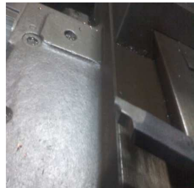
(b) outils de coupe utilisé pour façonner la tête sphérique
