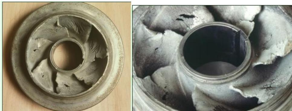
Figure (I.26). Effet de la cavitation (et/ou érosion) sur la roue d'une pompe centrifuge [20].
