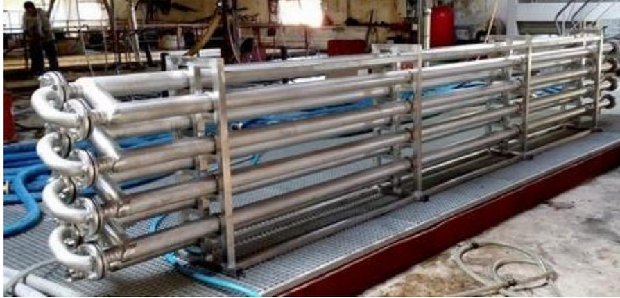
*Figure 4 Échangeurs a tubes co-axiaux*
