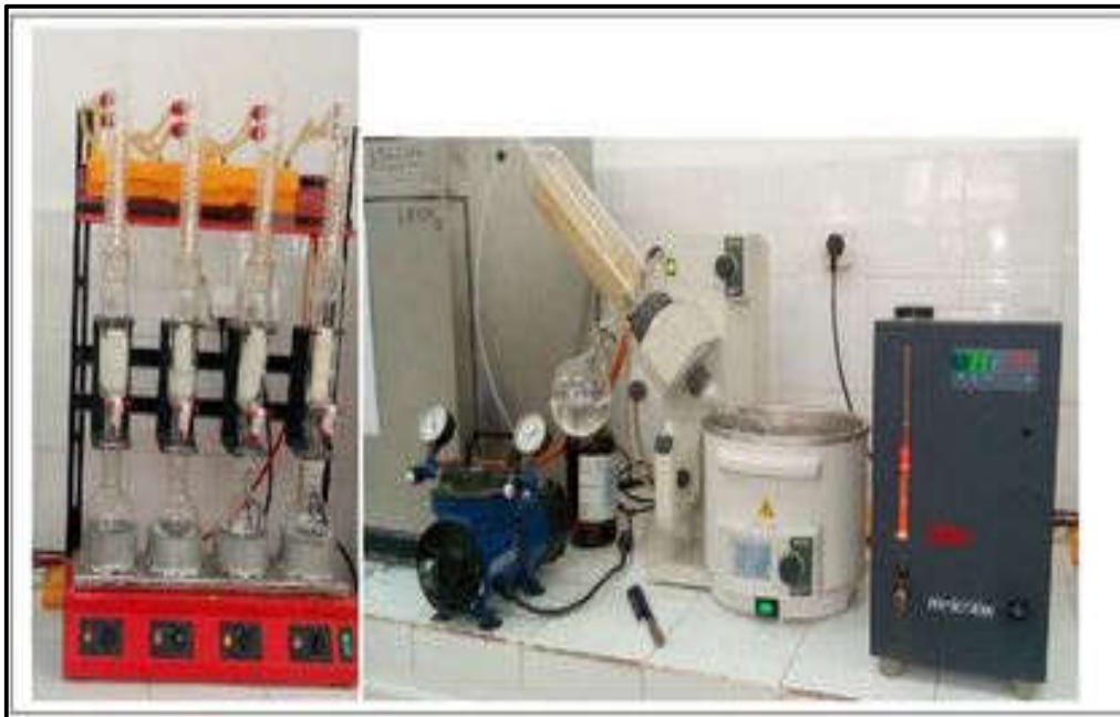
Figure 18 : Appareillage d'extraction des lipides (Soxhlet, réfrigérant et rota-vapeur).
