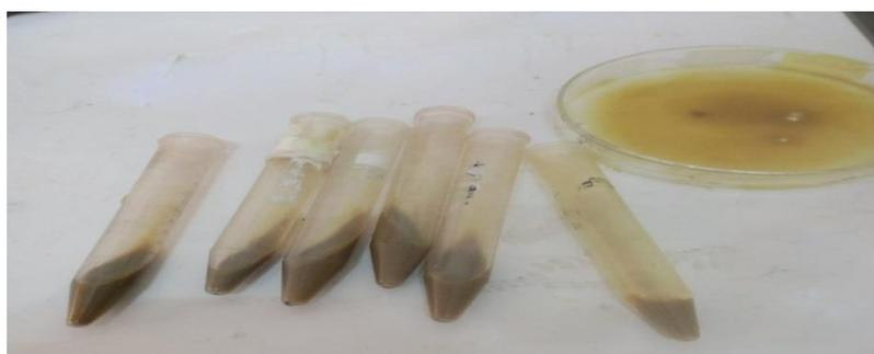
Puis séchés à 80 °C pendant une nuit. Par la suite, ils ont été calcinés à 450 °C pendant 2 heures, produisant des nanoparticules de ZnO pur sous forme de poudre cristalline.
