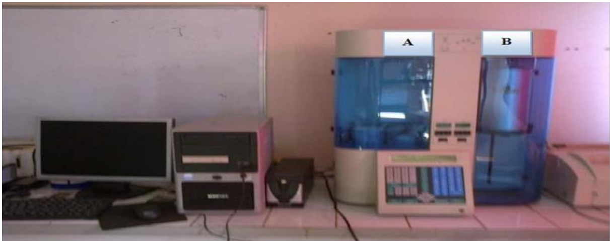
FigureII-5: Appareil NONOQAM employé pour les mesures BET
