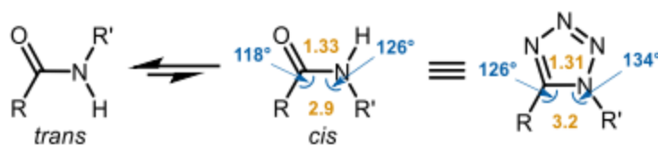
Figure I-12: Données géométriques d'une amide cis et de l'analogue tétrazole 1,5-disubstitué
