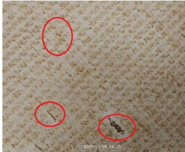
Figure III.2 : Photos d'observation visuelle interne des membranes usagées.
