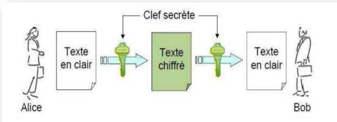
**Figure 1. 3:** Chiffrement symétrique [8]
