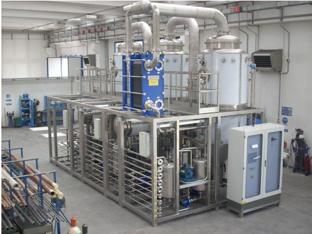
Figure V : Station de dessalement par évaporation. [19]
